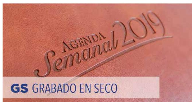
También llamado termograbado es una técnica de impresión en seco por transferencia térmica. El proceso requiere la fabricación de un cliché (troquel de metal) con el logotipo o diseño a estampar. El diseño se transfiere mediante el troquel al producto por acción de temperatura y presión, dejando la marca del grabado bajo relieve.
