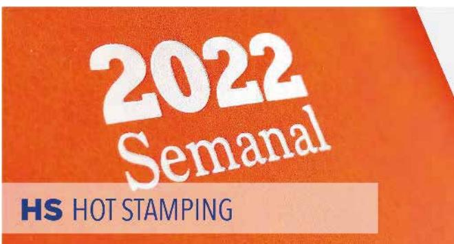
El procedimiento de hot stamping consiste en transferir un color contenido en un poliéster transportador (Llamado Foil o Película), a un material que se desea decorar, esto se logra a través de un procedimiento mediante un cliché y altas temperaturas.
